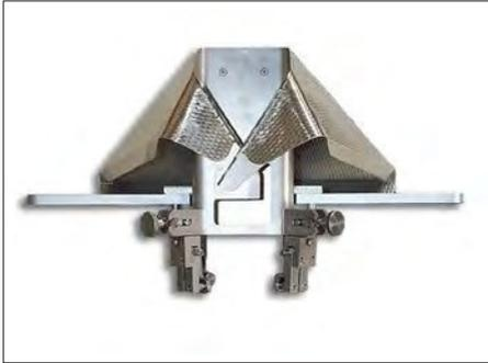
**Bild:** Kantenprägung an einer Rechteckformschulter
