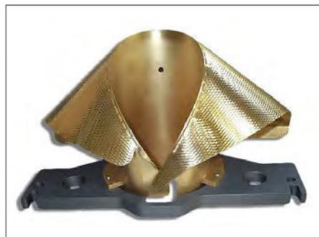
**Bild:** Formschulter mit kleinem Einlaufwinkel von 25°
