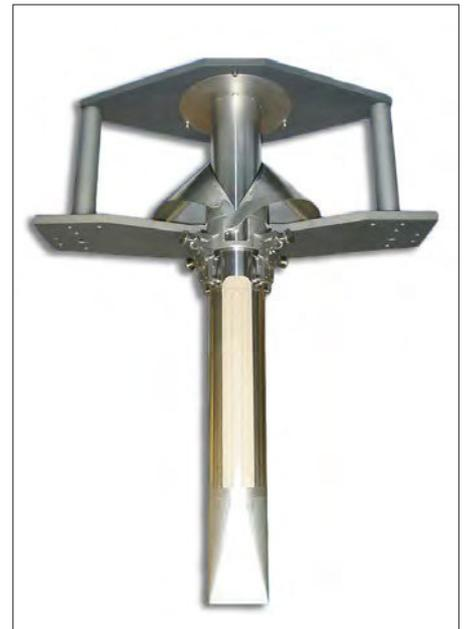
**Bild:** Formsatz mit Kantenprägung
